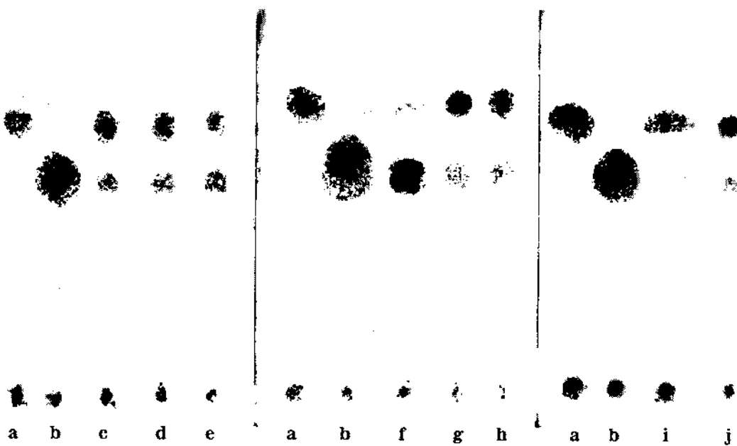
Fig. 2. Resultados correspondientes a la CCD para cada uno de los medios evaluados (imagen digitalizada). Fueron eluidos en una mezcla de acetato de etilo-hexano (2:3, v/v). Las bandas a y b correspondieron a los patrones AD y ADD, respectivamente; c medio maíz; d medio maíz I; e medio maíz II; f medio extracto de levadura; g medio Montes y Magaña; h medio peptona; i medio miel y j medio maíz III.
