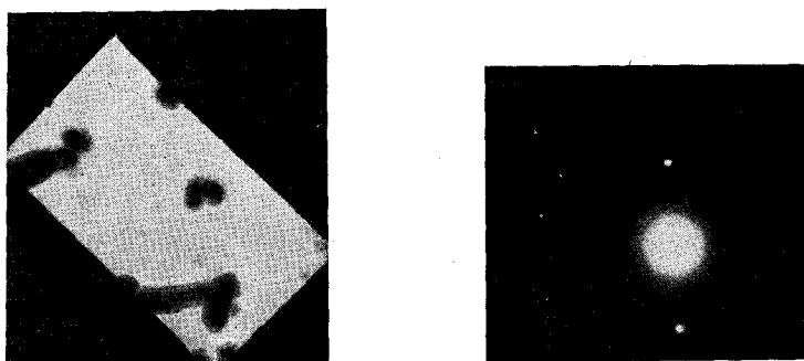
Fig. 6. Area seleccionada para la identificación de los Carburos después de 15 minutos a 1200°C con enfriamiento en agua. a. Aumento: 4000 X. b. Corte (310) CTI .
