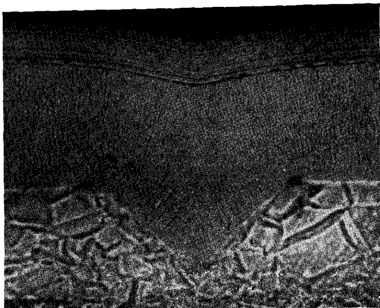
Fig. 1. b. Micro sección de un corte del recubrimiento con baño tipo Watts con agentes de adición mostrando alto grado de superficie nivelante agentes de adición. 4
