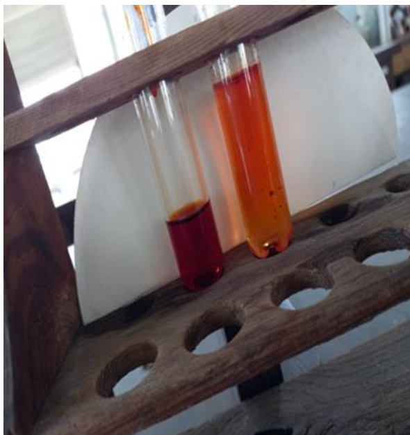
Fig. 8. Identificación de Zinc con Ditizona al 10% en medio básico.
