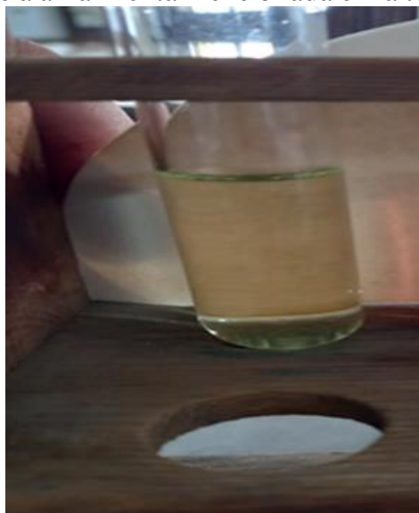
Fig. 6. Identificación de Zinc con ferrocianuro de potasio K_4[Fe(CN)_6] en medio ácido.
