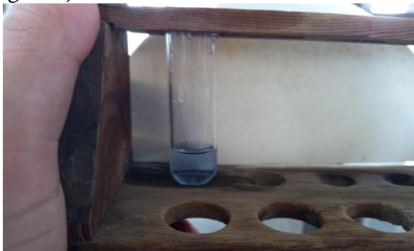
Fig. 5. Identificación de Zinc con violeta de metilo en medio ácido
