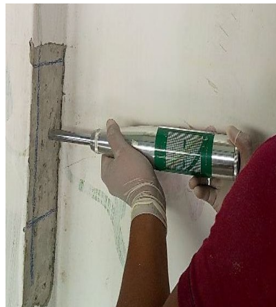
Fig. 3. Ejemplo de cómo fueron ejecutadas las mediciones de Esclerometría en una de las columnas.
