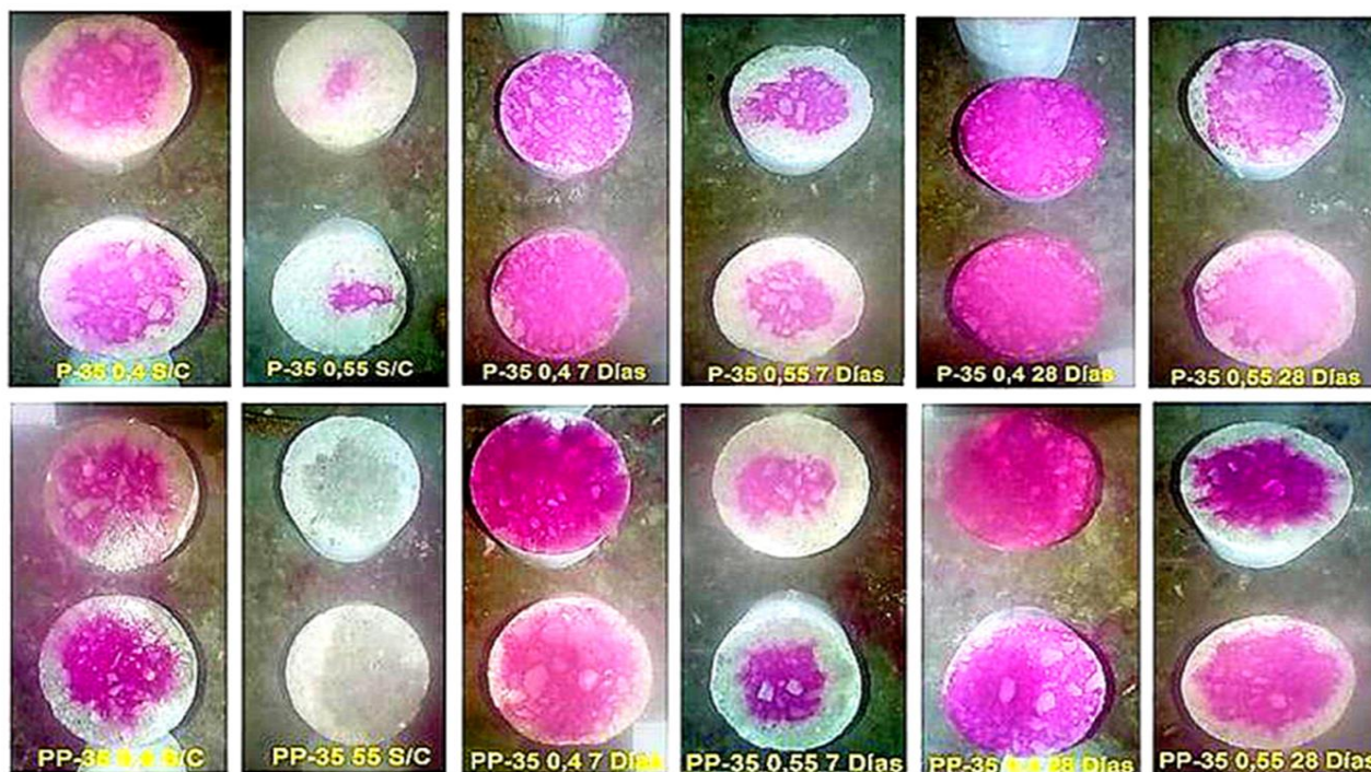
Fig. 7. Observación visual de las zonas de corte en las probetas a los 14 días de exposición en la cámara de carbonatación.
