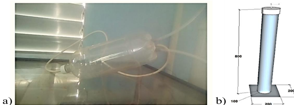
Fig. 2. Mezclador a) y estación humidificadora b) colocados en la parte exterior de la cámara.
