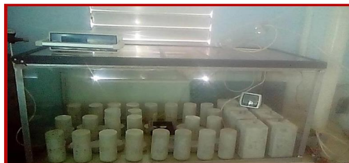
Fig. 1. Esquema de diseño de la cámara de carbonatación a) y foto con probetas cilíndricas de hormigón simple de forma cilíndrica en su interior b).
