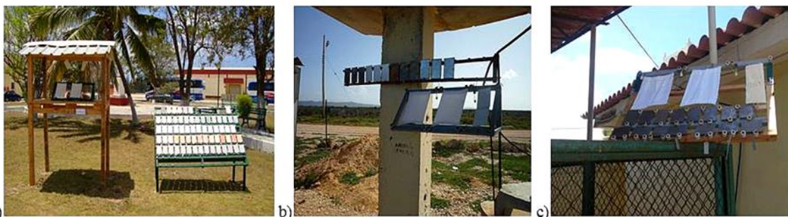
Fig. 2 a), b) y c). Ejemplo de tres tipos de sitios para la condición de exposición al exterior colocados en diferentes zonas de estudios del clima tropical costero de Cuba.
